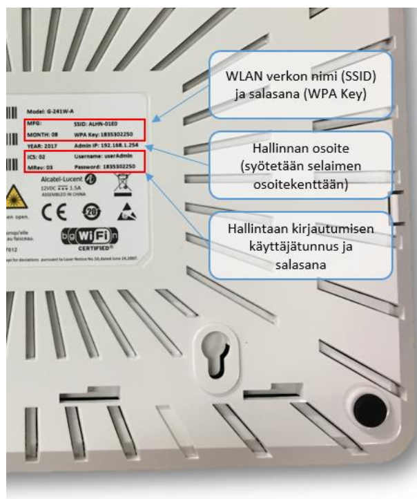
Kuva 3 Kuitupäätteen WLAN verkon ja hallinnan tunnuksat löytyvät laitteen pohjasta
